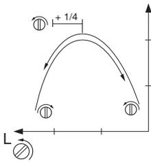
Ищите максимальные обороты холостого хода поворотом винта Л медленно по часовой стрелке или соответственно против часовой стрелки. Когда будут установлены максимальные обороты холостого хода, поверните винт Л на 1/4 оборота против часовой стрелки.
