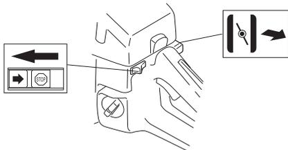
Если машина оборудована декомпрессионным клапаном (A): Его необходимо нажать, чтобы уменьшить давление в цилиндре и облегчить запуск машины. При запуске машины всегда пользуйтесь декомпрессионным клапаном. После запуска машины он автоматически вернется в свое первоначальное положение.
